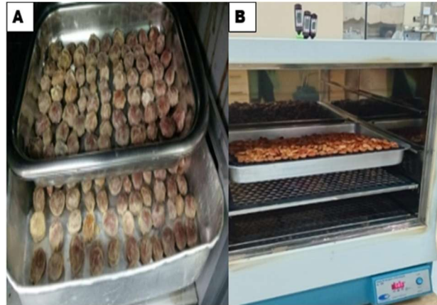
Figura 4- Secagem em forno industrial (A) e Secagem em estufa de indução (B).
