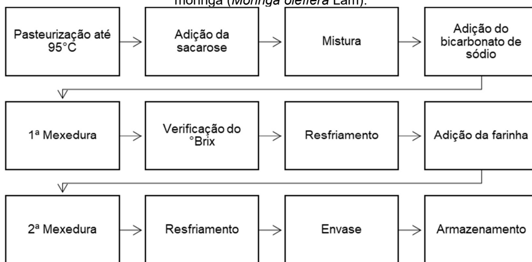
Figura 4. Fluxograma do processamento do doce de leite com adição de farinha da semente de moringa ( Moringa oleífera Lam).
